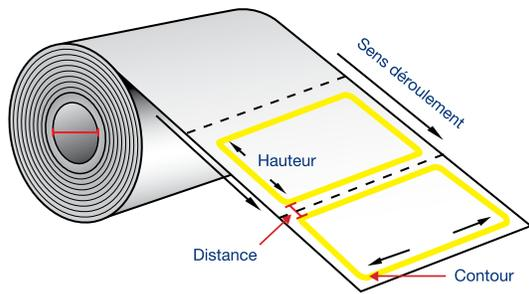
**MATÉRIEL UTILISÉ AVEC UNE IMPRIMANTE THERMIQUE :****Papier transfert thermal :**
