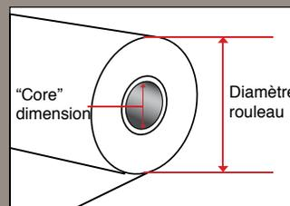
**Diamètre du rouleau vs diamètre du mandrin (core)**
